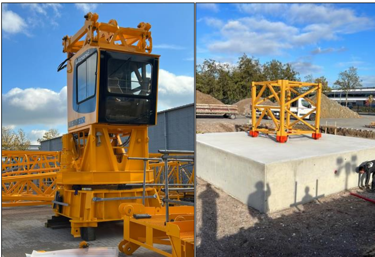
Afbeelding 5 Situering beoogde elektrische torenkraan met fundering
