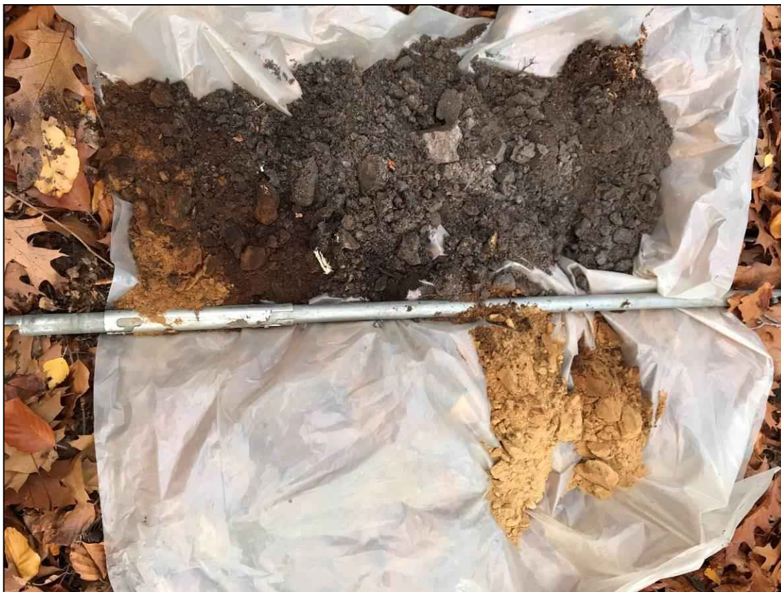
Figuur 5: Het profiel van boring 5 (leesrichting van rechtsboven naar rechtsonder).
