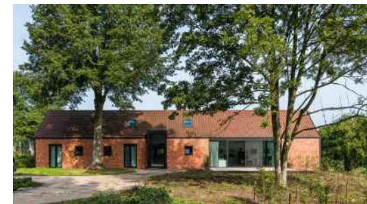
Figuur 14: Impressies van de massa en vorm . Toepassen van een eenvoudige hoofdvorm met een rechthoekige plattegrond en een ruime zadeldak.
