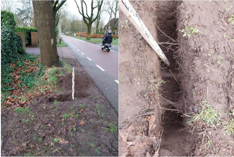
Afbeelding 4: groeiplaatsonderzoek 1 links overzichtsfoto, rechts binnenkant profielsleuf
