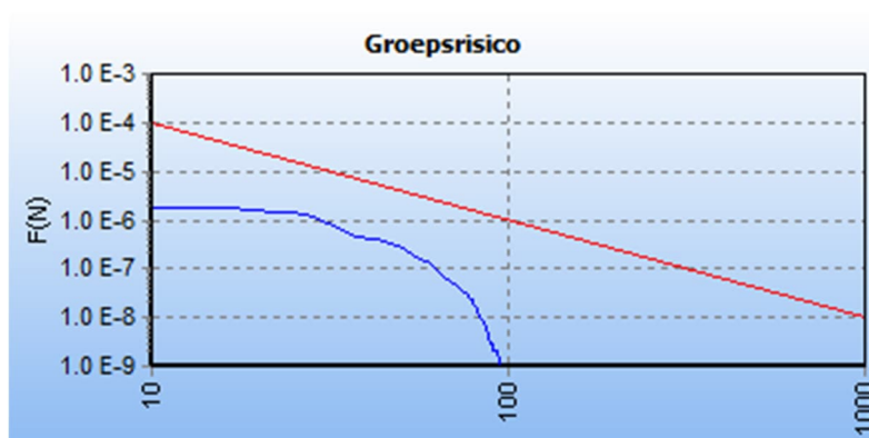
Afbeelding 7 fN-curve buisleiding Z-522-01-deel-1, na planrealisatie
