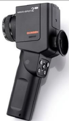
Figuur 5: Luminantiemetere en lichtafstandmeter
