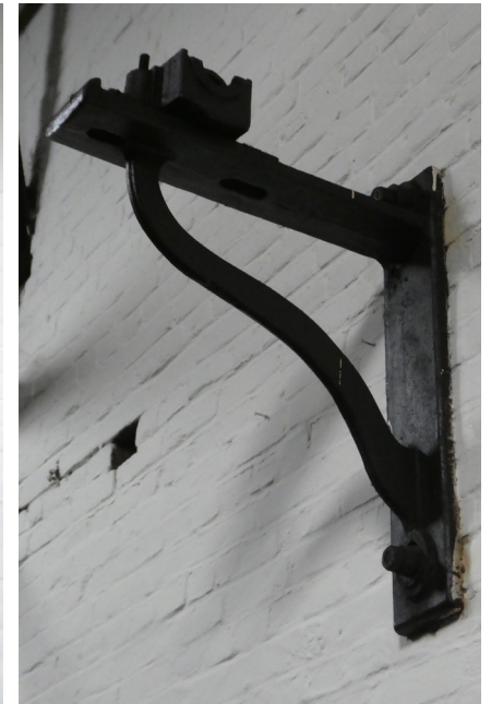
Gietijzeren steun van een aandrijfjas.
