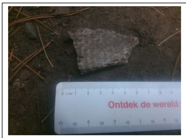
Foto 23. Asbest plaatmateriaal op het maaiveld
