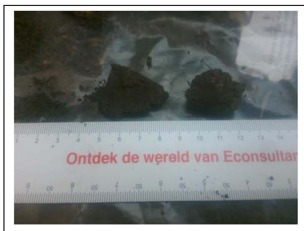
Foto 22. Asbestplaatmateriaal asbestinspectiegat A19
