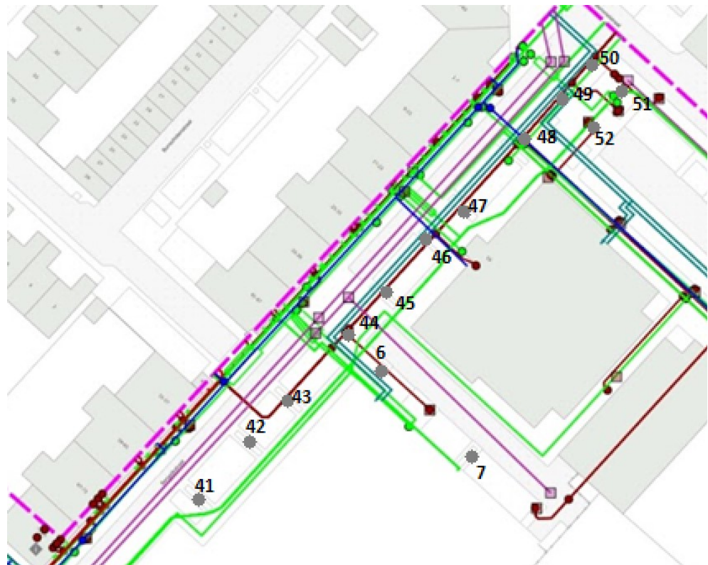
Afbeelding 57. Kabels en leidingen in plantspiegel Rode Esdoorns en Spaanse Aken
