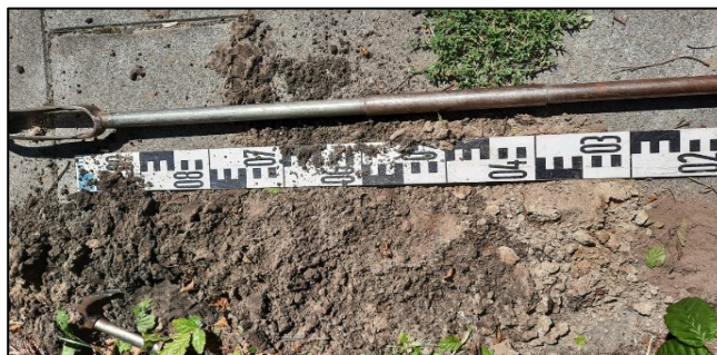
Afbeelding 50. Opbouw bodemprofiel profielboring 2
