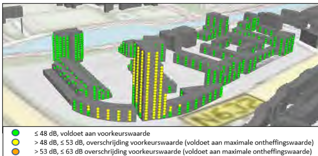
Figuur 11: Berekende geluidbelastingen vanwege Ringbaan West
