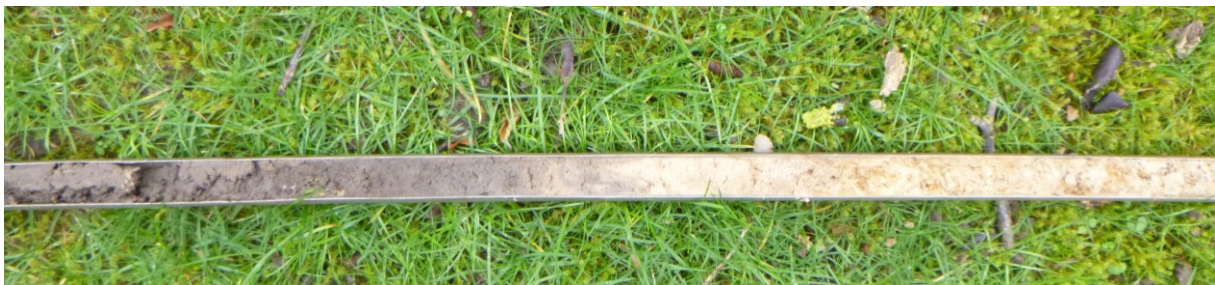
Figuur 19: Foto van de kenmerkende bodemopbouw binnen het plangebied met links de bouwvoor, rechts van het midden de AC-horizont en geheel rechts de sterk lemige C-horizont met oxidatievlekken.
