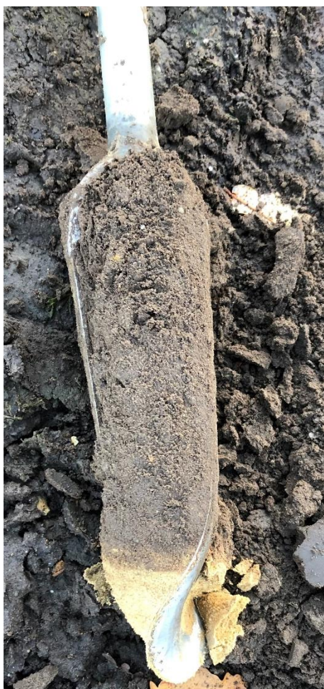
Figuur 8: Boring 2 met scherpe overgang van de onderzijde van de bouwvoor naar de C-horizont.
