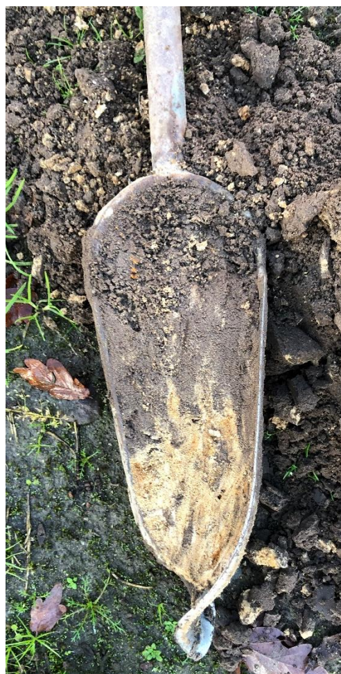
Figuur 9: Boring 6 met diffuse overgang van de bouwvoor in de C, waarbij de C-horizont ten minste 10cm geroerd is.
