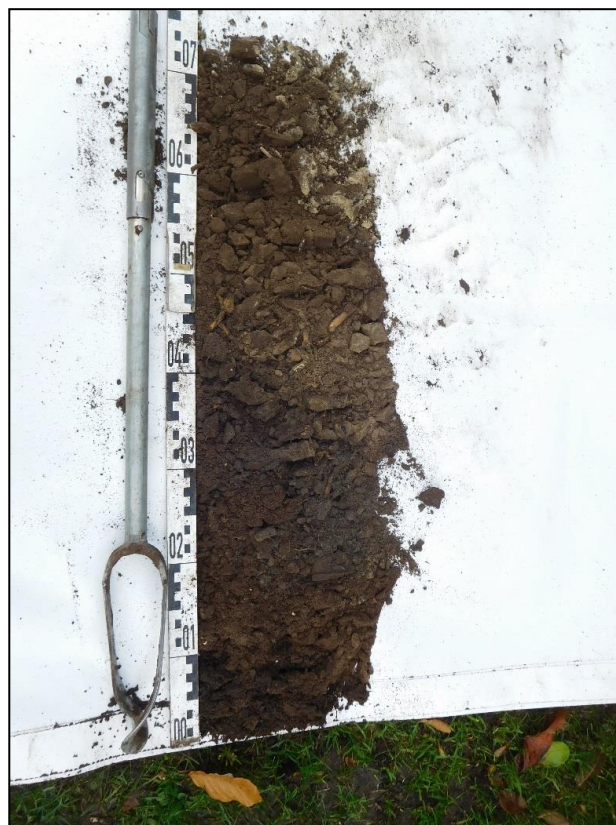
Foto links: profielsleuf 2 met vette humeuze toplaag en verder zandig profiel met puin
