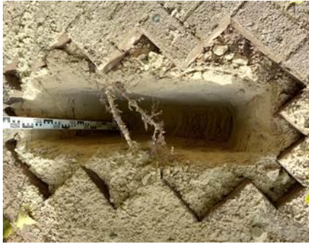
Afbeelding 7: oppervlakkige opnamebeworteling, direct onder de verharding
