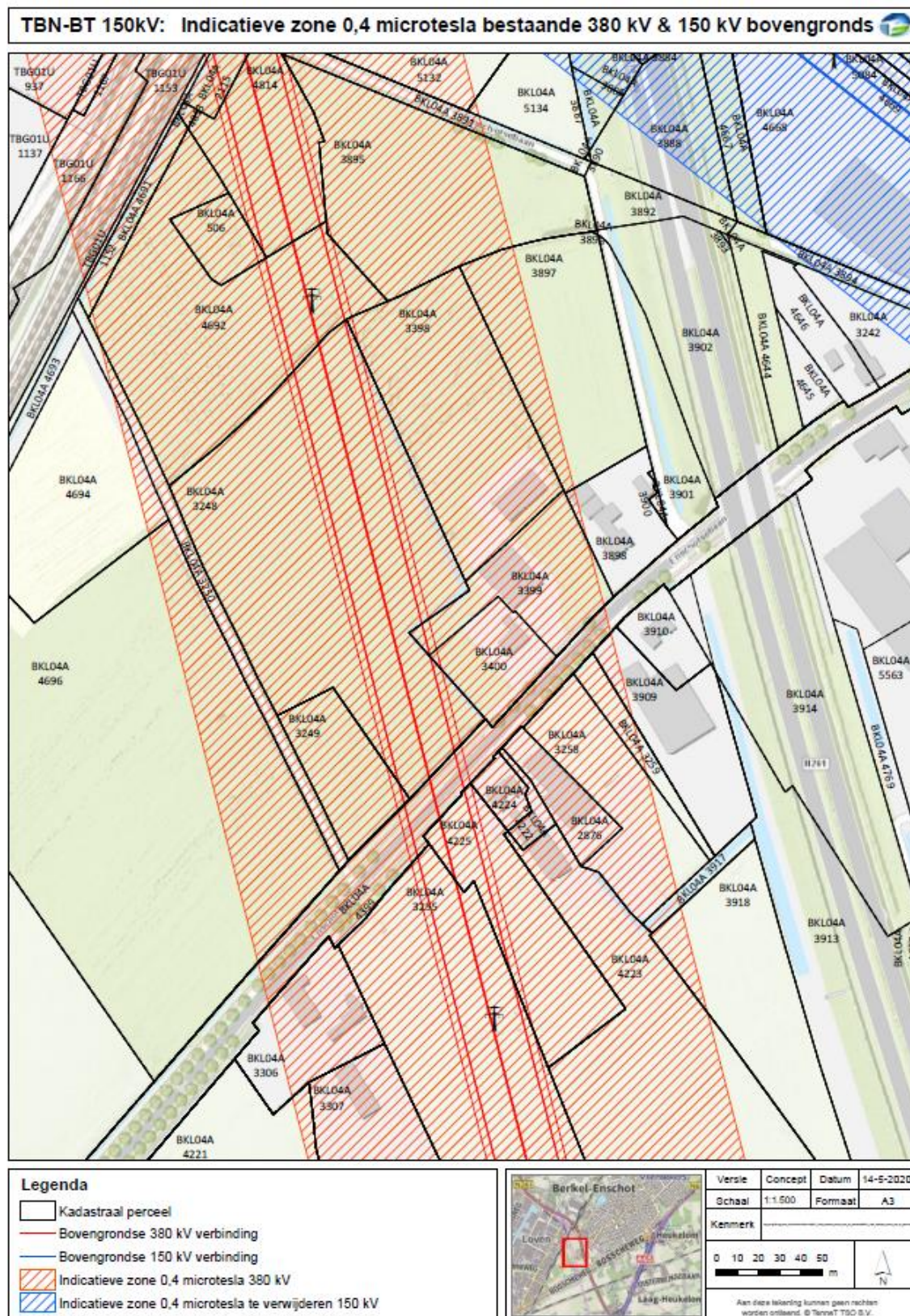
Figuur 1 Indicatieve magneetveldcontour 380kV (zienswijze 4.12)
