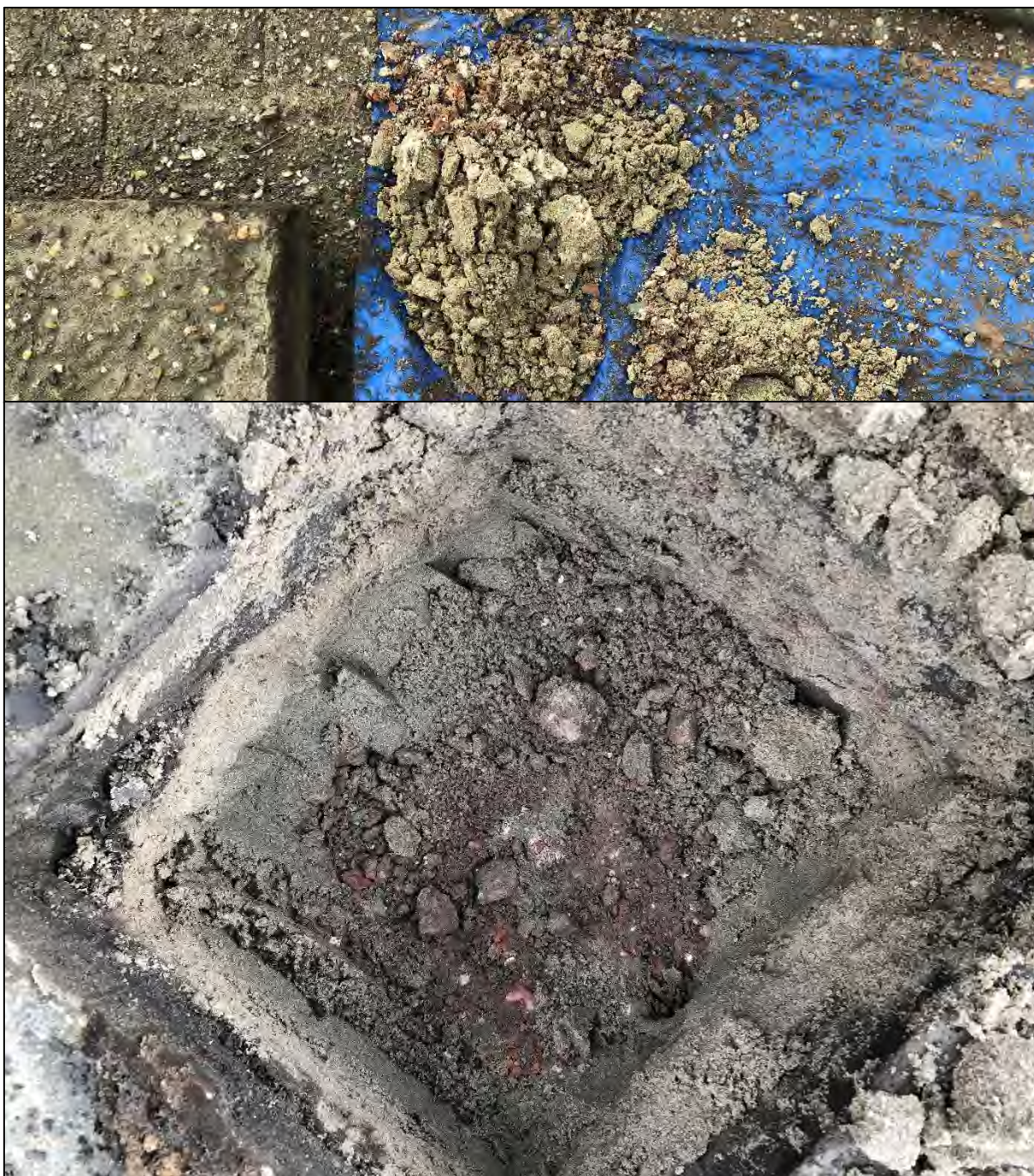
Boring 5, één van de drie pogingen. Met een shep is nog gepoogd door de puinlaag te raken.
