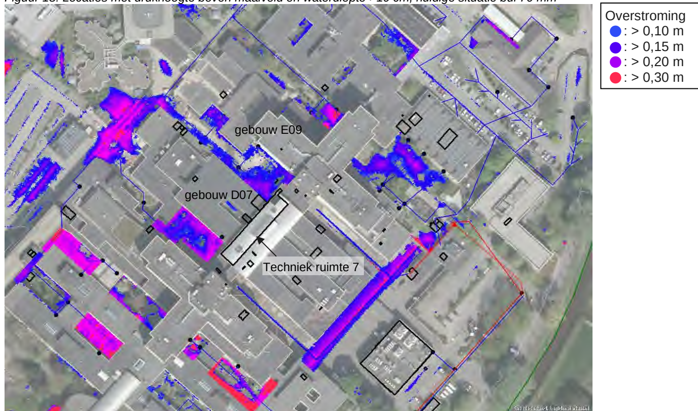
Figuur 18: Locaties met drukhoogte boven maaiveld en waterdiepte >10 cm, huidige situatie bui 70 mm
