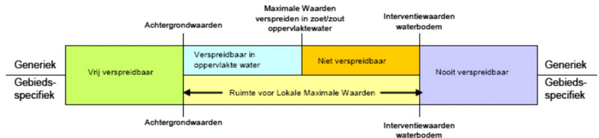
FIGUUR 2: Normstelling voor verspreiden van baggerspecie in oppervlaktewater in het generieke- en gebiedsspecifieke kader
