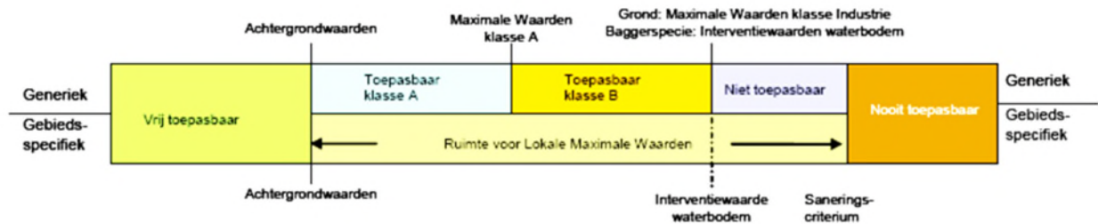
FIGUUR 1: NORMSTELLING VOOR TOEPASSEN VAN GROND EN BAGGERSPECIE IN OPPERVLAKTEWATER IN HET GENERIEKE- EN GEBIEDSSPECIEFIE KADER
