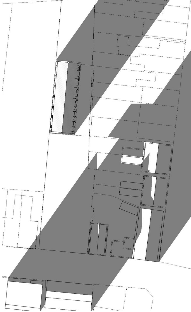
Bezonning (bestaande situatie) – 21 juni om 20.30 uur
