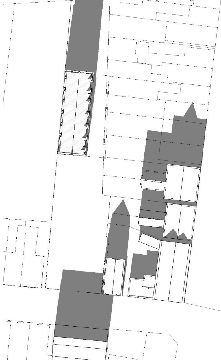
Bezonning (bestaande situatie) – 21 juni om 18.00 uur
