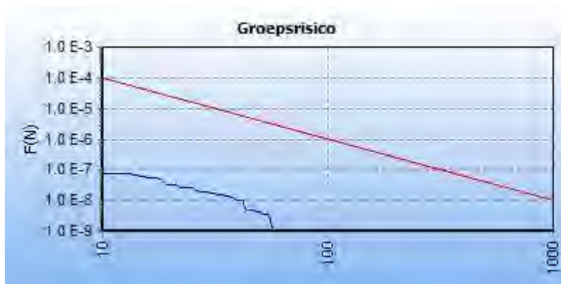
5.5 Figuur 5.5 FN curve voor 6449_leiding-Z-528-02-deel-1 van N.V. Nederlandse Gasunie voor de kilometer tussen stationing 0.00 en stationing 810.00
