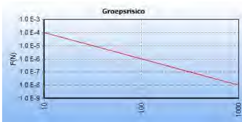
5.6 Figuur 5.6 FN curve voor 6449_leiding-Z-528-03-deel-1 van N.V. Nederlandse Gasunie voor de kilometer tussen stationing 0.00 en stationing 1000.00
