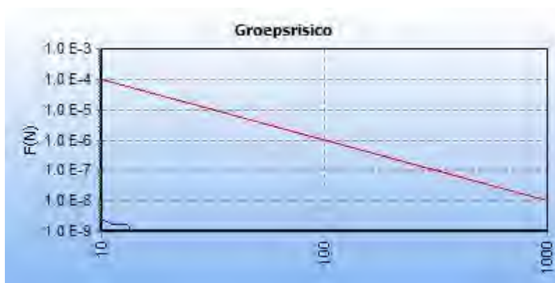
5.5 Figuur 5.5 FN curve voor 6449_leiding-Z-528-02-deel-1 van N.V. Nederlandse Gasunie voor de kilometer tussen stationing 0.00 en stationing 810.00
