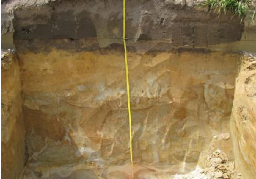
Afb. 1 Zicht op Profiel 7.6, middendeel onderzoeksgebied Tradepark Noord. Een circa 50 cm dikke homogene zandige (Zs3) eolische toplaag op fluvioperiglaciale siltrijke, sterk gebioturbeerde afzettingen. Het oorspronkelijke bodemprofiel is geheel opgenomen in de verploegde toplaag. Bron: Tol 2015.
