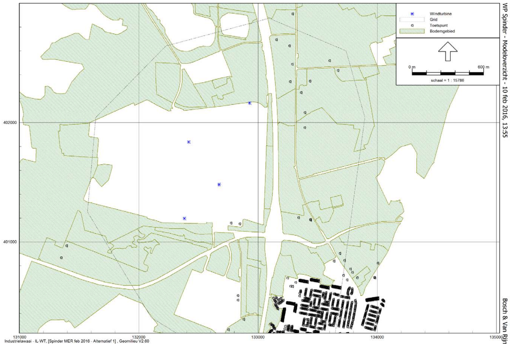
Figuur 7 - Onderdelen van het rekenmodel in GeoMilieu: Locatie van windturbines (ter illustratie zijn de locaties van alternatief 1 weergegeven.
