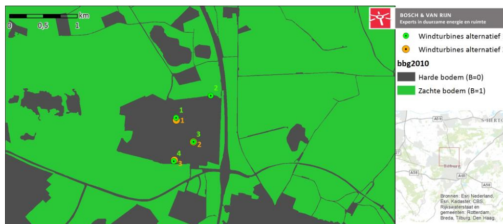
Figuur 2 - Bodemabsorptie en -reflectie rondom het windpark.
