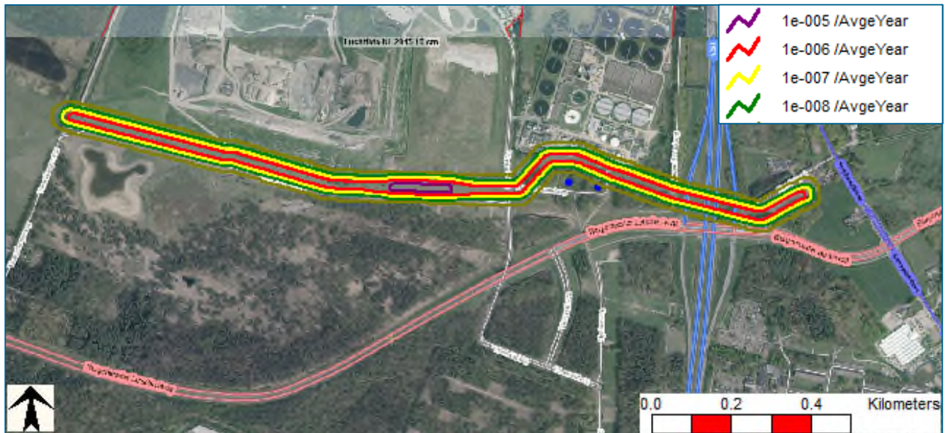
Figuur 4.3: Plaatsgebonden risicocontour 8" leiding beïnvloed door windturbine
