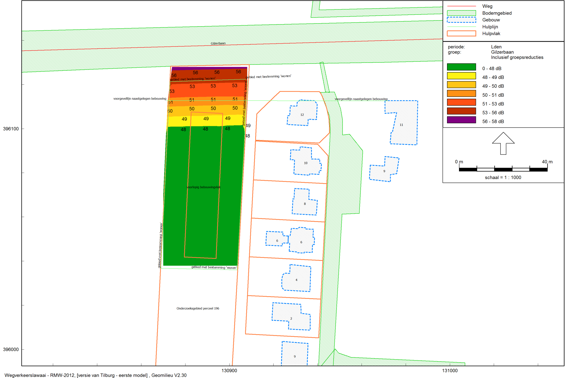
Figuur 4 Weergave berekende geluidcontouren op 4,5 meter hoogte inclusief aftrek artikel 110g Wg
