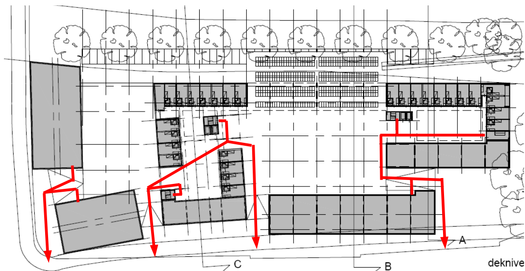
Figuur 4: weergave uitgangen met route van vluchtwegen
