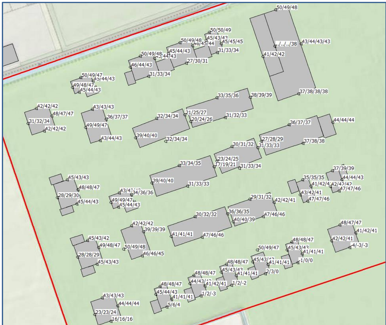
Afbeelding 6 Geluidbelastingen Lden (excl. aftrek art. 110g Wgh) cumulatief Berekende geluidbelastingen op een hoogte van 1,5 / 4,5 / 7,5 meter
