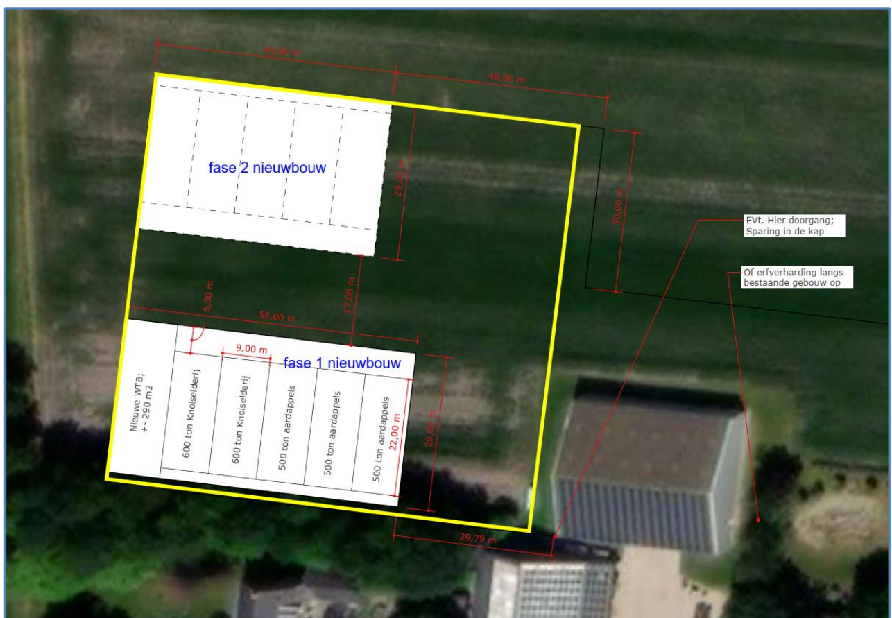
Afbeelding 2: Projectie nieuwbouw met fase 1 en fase 2
