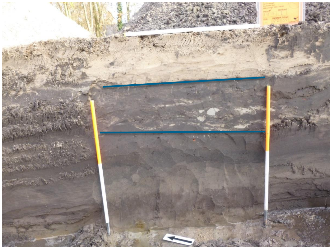
Afbeelding 4. Profiel 2 De blauwgroene lijnen geven de scheiding tussen cunetzand en recente ophogingen en recente ophoging en oorspronkelijke bodem.
