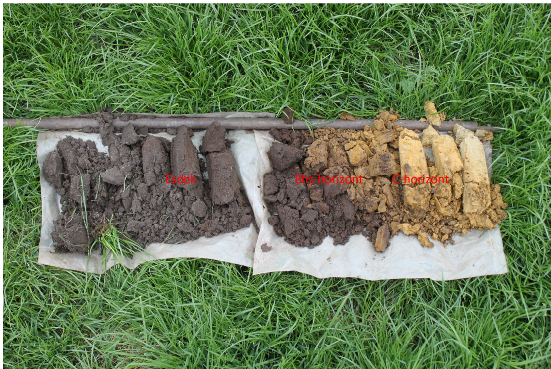
Opname van boring 4: in de boring is een deels aangetaste podzolgrond te herkennen
