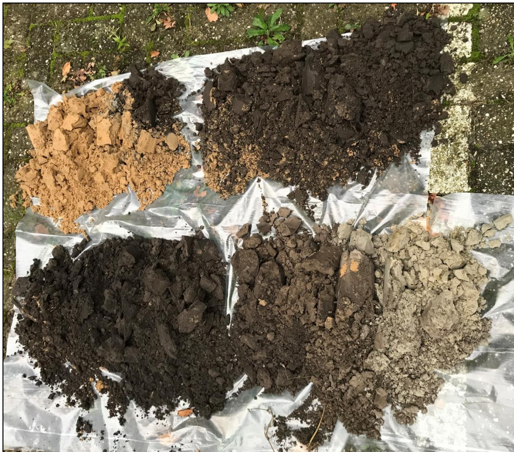
Figuur 6. Boorprofiel 1. Leesrichting is van links naar rechts (0 – 310 centimeter) (Foto: 19 oktober 2020).
