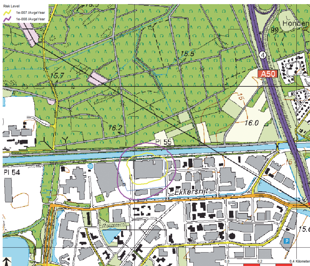
Afbeelding 4.3: Plaatsgebonden risicocontouren 10^{-7} -contour en 10^{-8} -contour van Van de Anker
