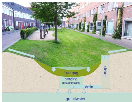
Figuur 5-2 Voorbeeld van de werking van een wadi (bron: website www.klimaatadaptatienederland.nl van Kennisportaal Klimaatadaptatie, 2020)
