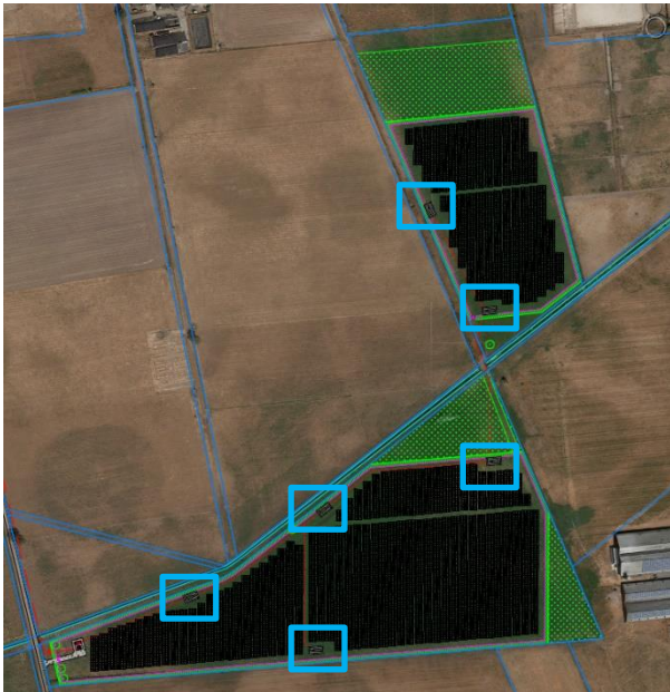
Figuur 4: Oude situatie 6 transformatoren (blauw vierkant)
