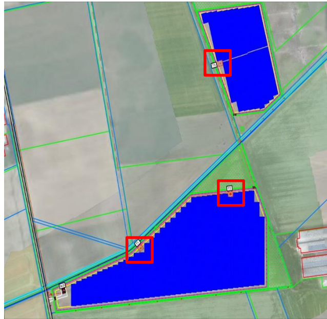
Figuur 5: Nieuwe situatie 3 transformatoren (rood vierkant)
