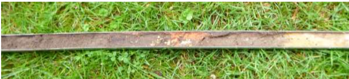
Figuur 23: Foto van de relatief grote hoeveelheid baksteenpuin die langs de zuidrand van het plangebied is aangetroffen; in dit geval in boring 9
