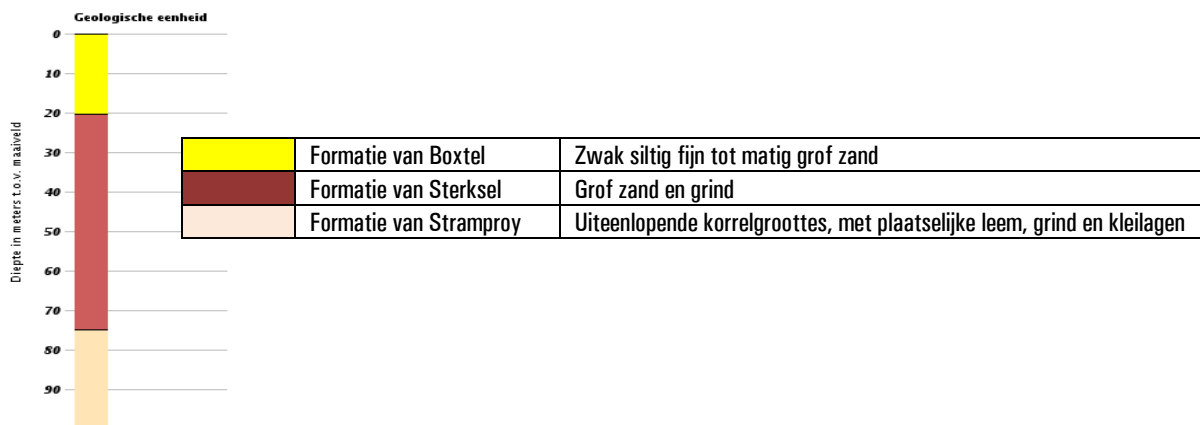
Figuur A: opbouw ondergrond.
