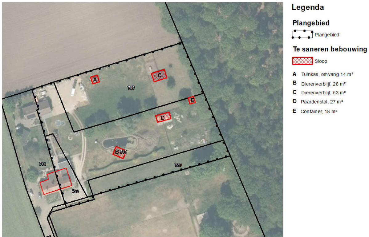
Figuur 10: Te slopen bebouwing binnen het plangebied
