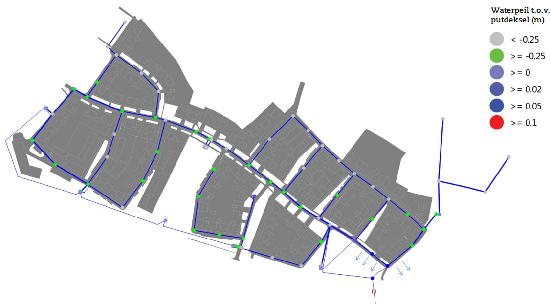
Figuur 2 Rekenresultaat hemelwaterstelsel bij bui met intensiteit 60 mm/u (schematische weergave)
