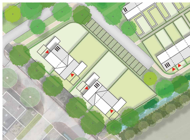
Figuur 32. Aansluiting Parkeerkoffer op trottoir en halfverhardingstrook
