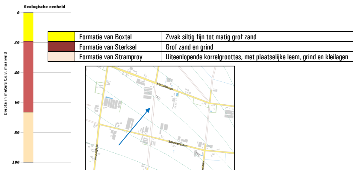
Figuur A: opbouw ondergrond.
