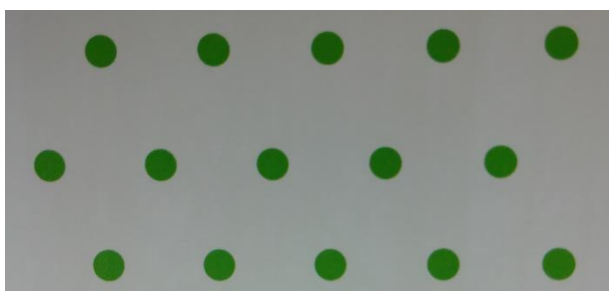
Figuur 4: Verspringend plantverband. De afstand tussen de planten in een rij is 1,5 meter. De afstand tussen twee rijen is ook 1,5 meter.
