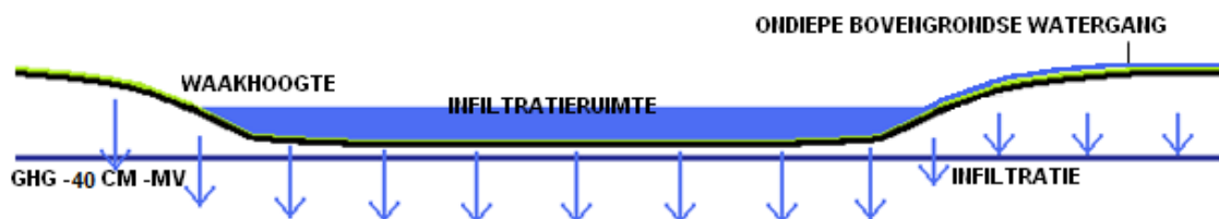
Figuur 38: Schematische weergave van infiltratievoorziening.
