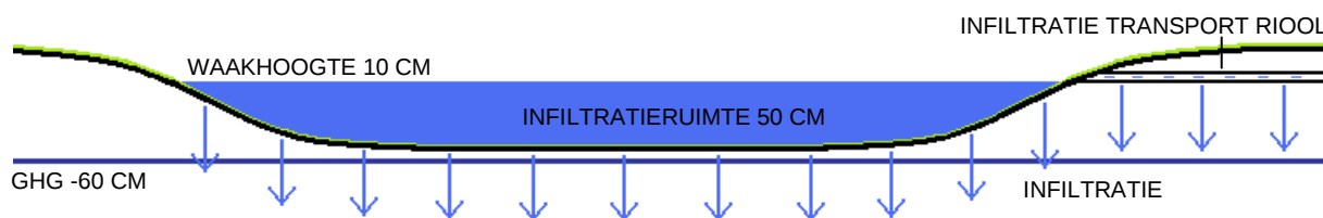
Figuur 31: Doorsnede infiltratieveld Lieropsedijk 28
