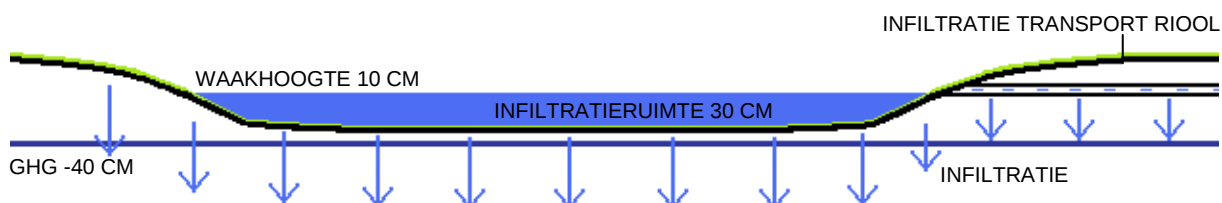
Figuur 33: Doorsnede infiltratieveld Lieropsedijk 47
