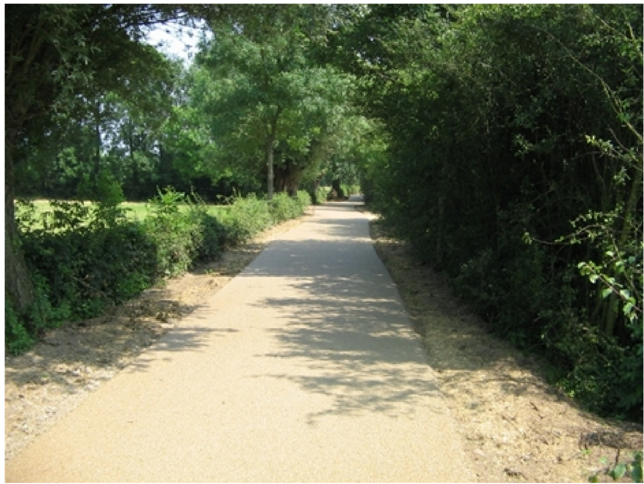
Grindpave van Dura Vermeer heeft de uitstraling van een grindpad en bezit de gemakken van een asfaltpad: - Pad heeft direct de natuurlijke kleur en uitstraling van traditioneel grindpad. - Onderhoudsvriendelijk. - Lange levensduur. - Ideaal voor zorginstellingen, recreatieparken en paden op een begraafplaats of golfbaan.
