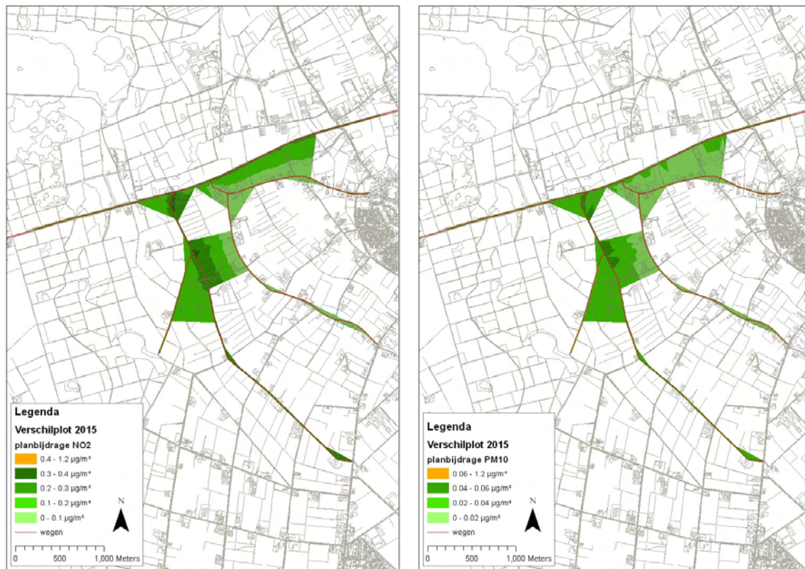
Figuur 4.1 Effect van de realisatie van het plan Heihorsten op de concentraties \text{NO}_2 en \text{PM}_{10} voor het jaar 2015
