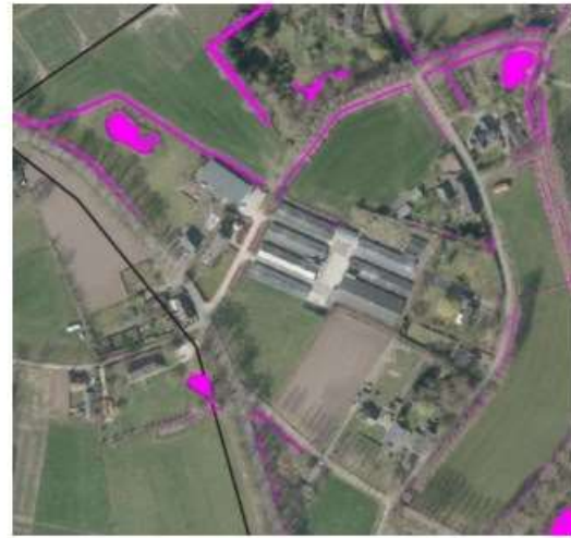
Figuur 4-3: Weergave van waterpeil 5,24 mNAP. Alle paarse vlakken hebben huidig een maaiveldhoogte lager dan 5,24 mNAP.
