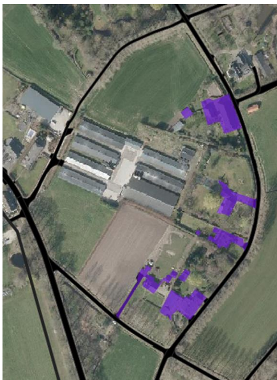
Figuur 4-2: Overzicht bestaande verharding, met in zwart de bestaande wegen, in paarse blokken de terreinverharding van de percelen die niet worden aangepast. de overige verharding binnen het plangebied wordt verwijderd.
