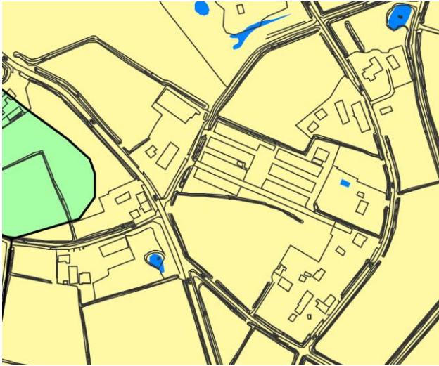
Figuur 2-4: Uitsnede uit afkoppelkansenkaart grondwatertrappen. in geel is het gebied aangegeven met een matige afkoppelkans (grondwatertrap III*, V en V*).
