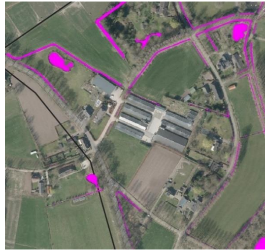
Figuur 4-3: Weergave van waterpeil 5,24 mNAP. Alle paarse vlakken hebben huidige een maaiveldhoogte lager dan 5,24 mNAP.
