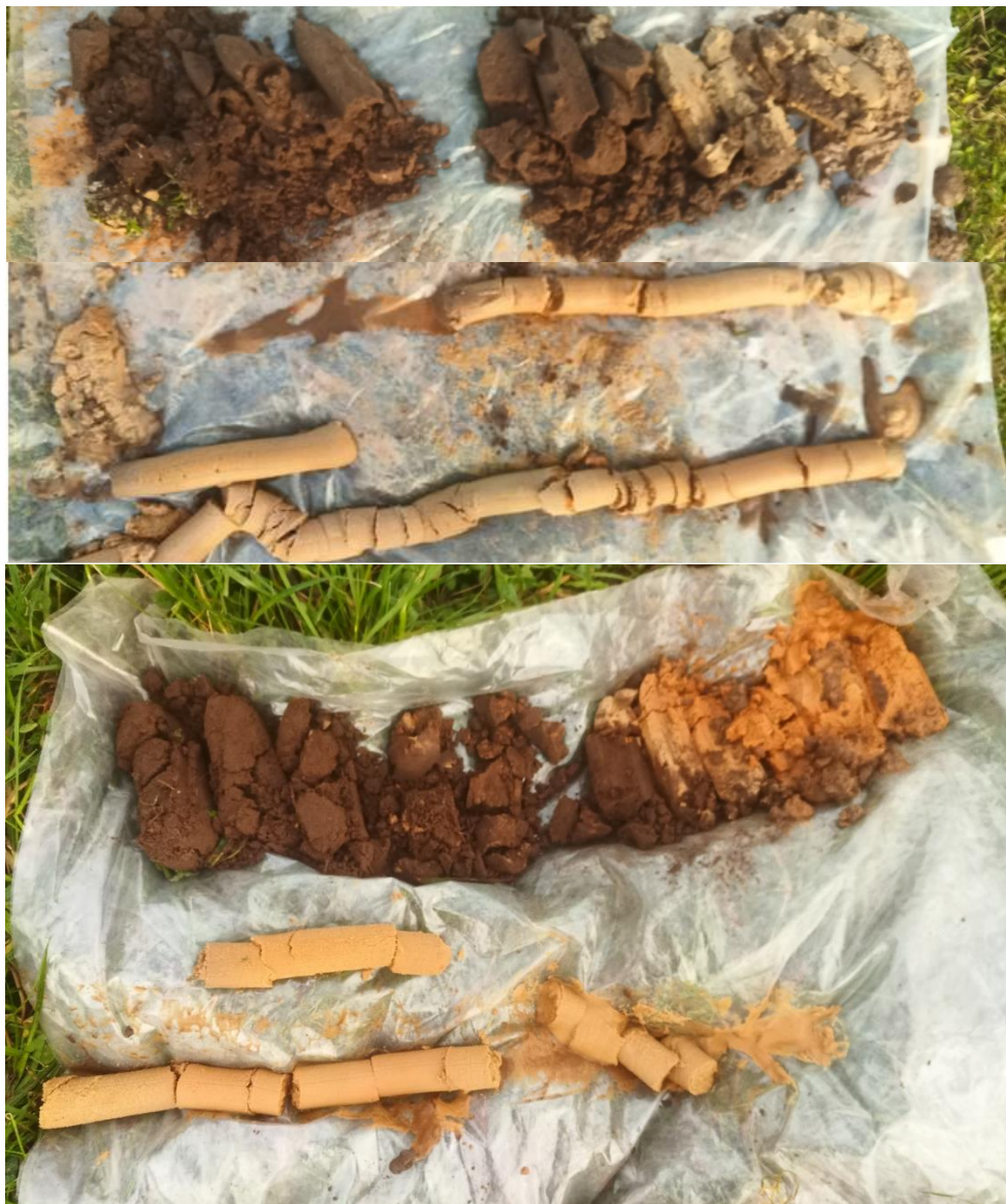
Afbeelding 2: Boorprofiel meetpunten A en C, leesrichting per halve meter van linksboven naar rechtsonder
