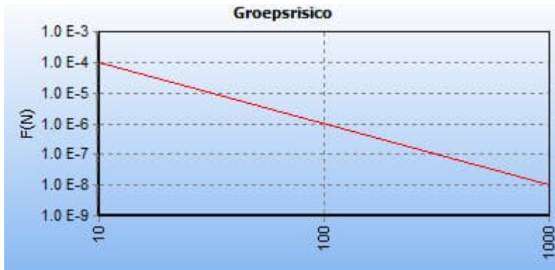
Afbeelding 7 fN-curve buisleiding A-525-deel-1, huidige situatie
