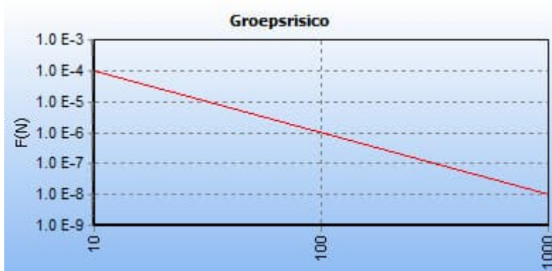
Afbeelding 14 fN-curve buisleiding A-526-deel-1, toekomstige situatie
