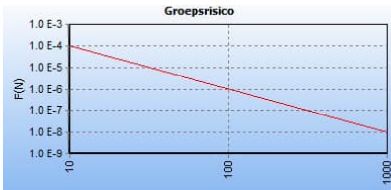
Afbeelding 9 fN-curve buisleiding A525-deel-1, toekomstige situatie
