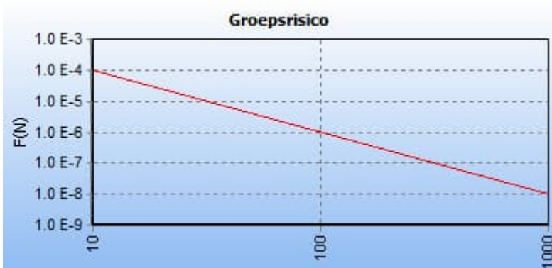
Afbeelding 12 fN-curve buisleiding A-526-deel-1, huidige situatie
