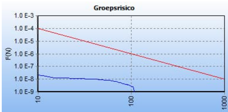
Afbeelding 19 fN-curve buisleiding A-527-deel-1, toekomstige situatie
