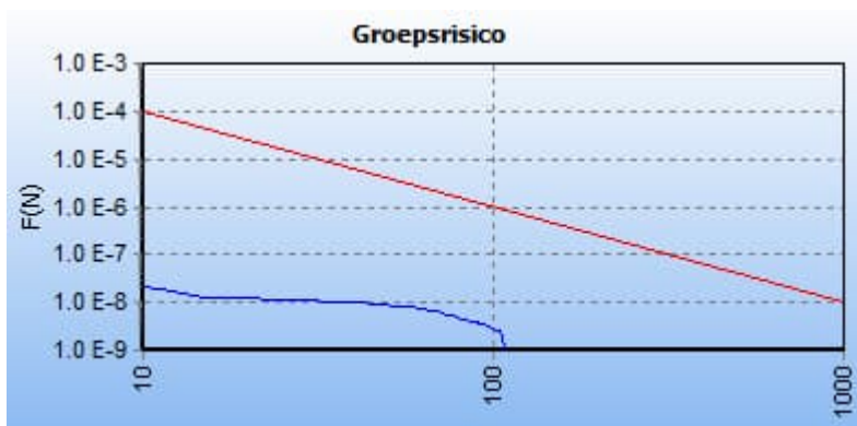
Afbeelding 17 fN-curve buisleiding A-527-deel-1, huidige situatie
