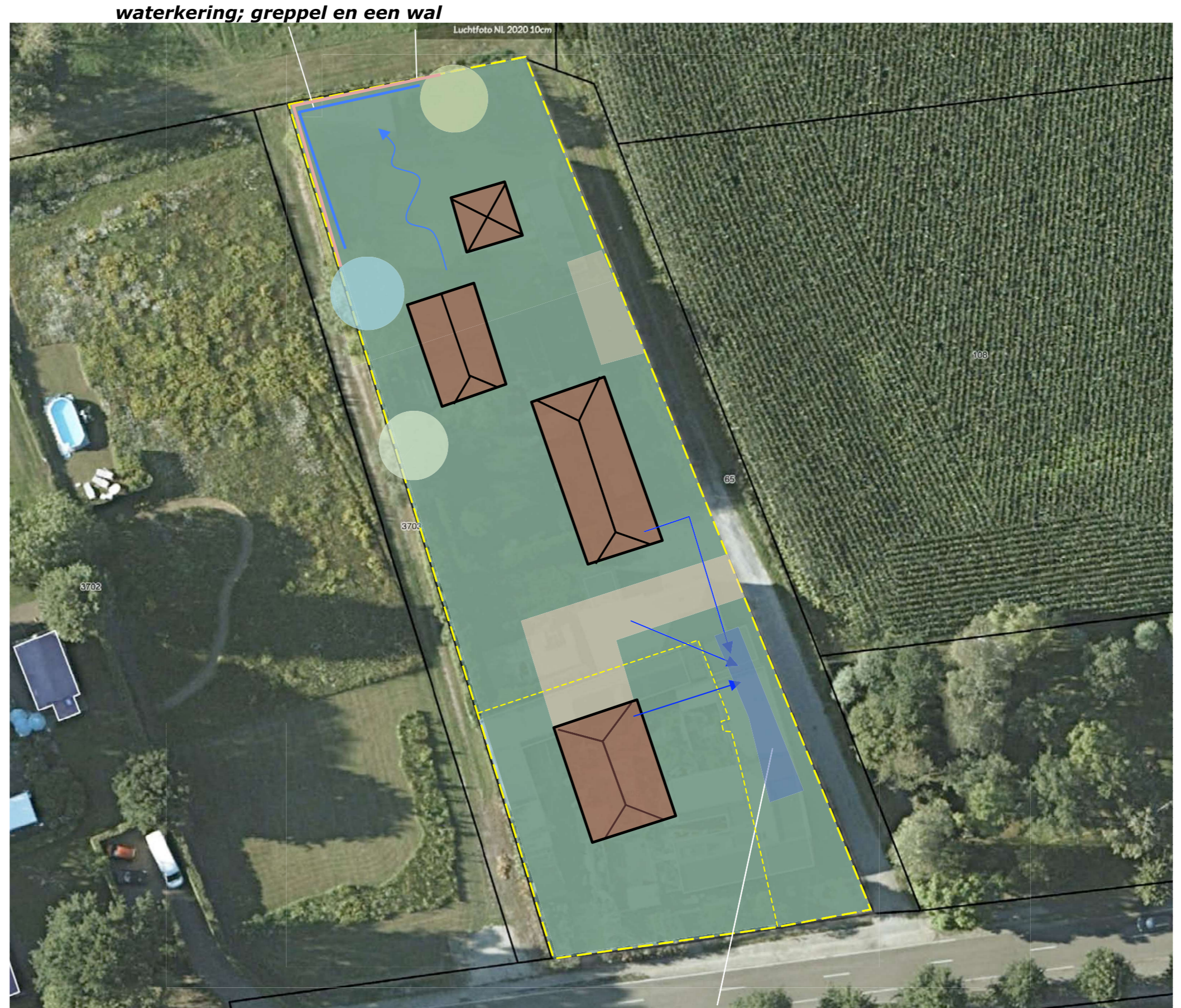
hemelwater van de daken en gemeenschappelijk erf in de wadi
