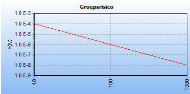
5.2 Figuur 5.2 FN curve voor 7095_leiding-Z-515-06-deel-1 van N.V. Nederlandse Gasunie voor de kilometer tussen stationing 0.00 en stationing 0.00
